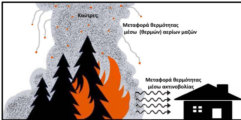
Σχέδιο 2. Τρόποι ροής της θερμότητας σε μια δασική πυρκαγιά, που εξελίσσεται πλησίον κτιρίου και απεικόνιση πιθανού τρόπου μετάδοσης δασικής πυρκαγιάς με μεταφερόμενες καύτρες σε κτίρια χωρίς την παρουσία άνεμου υπό συνθήκες πρόσκαιρης ηνεμίας, ή ατμοσφαιρικής ευστάθειας
